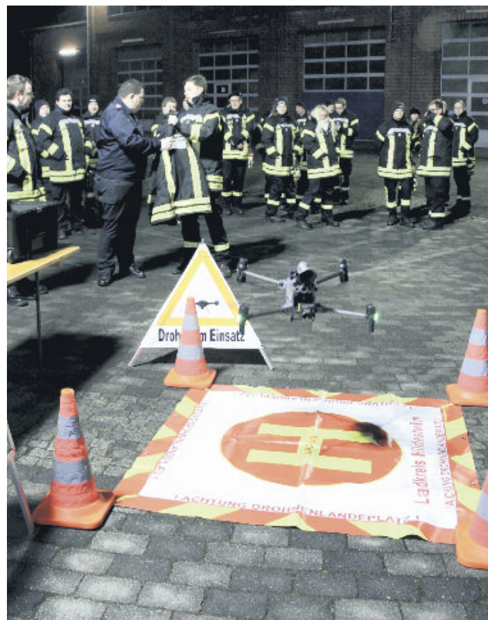
Die Drohne ist unter anderem mit Lautsprecher für Durchsagen und Suchscheinwerfer ausgestattet.
